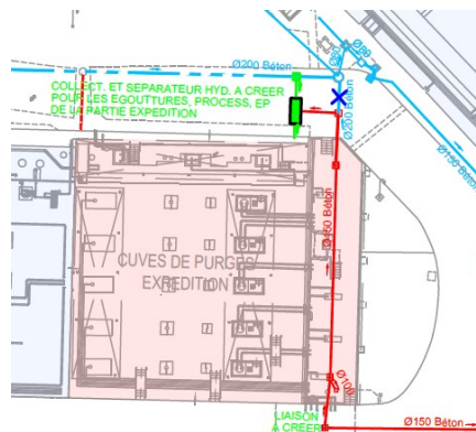
Séparateur à hydrocarbure non réalisé (en vert)
